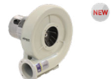
CMA/EC Ventiladores centrífugos de media presión y simple aspiración, envoltorio y turbina en fundición de aluminio y motor EC Technology IE5
